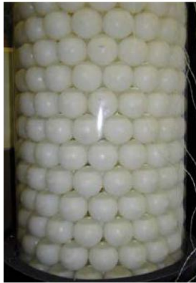
Abbildung 47: Ein experimenteller Latentwärmespeicher mit makroverkapseltem PCM (Paraffin); Quelle: Ciril Arkar, Universität Lubiljana, Slowenien
